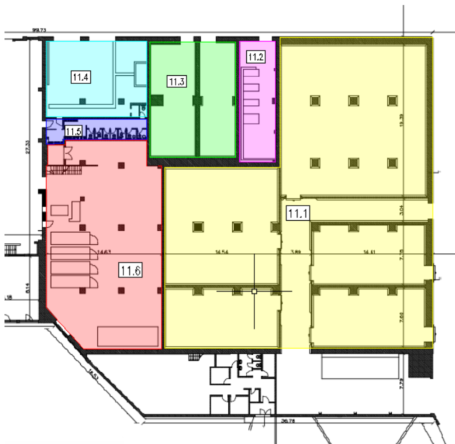
Figura 2 – Subdivisão do Corpo 11: 11.1 – Zonas técnicas de frio; 11.2 – Zona de bombas/motores; 11.3 – Armazéns; 11.4 – Zona das caldeiras; 11.5 – Instalações Sanitárias; 11.6 – Escritórios e, possivelmente, embalagem.
